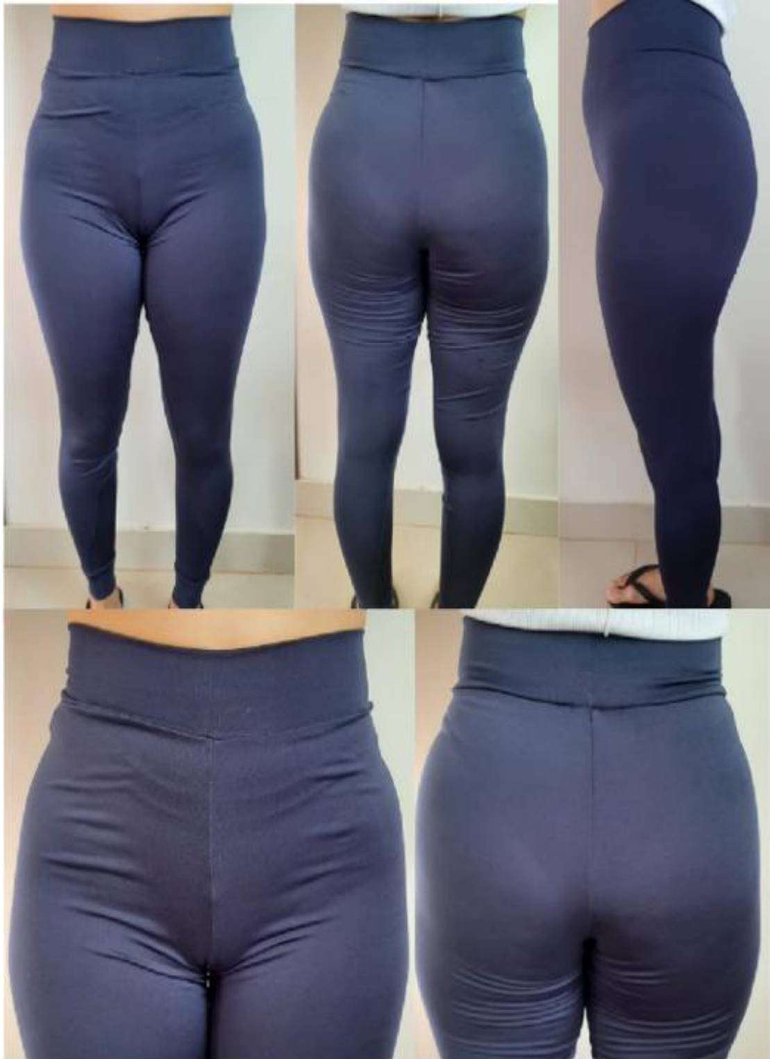
Figura 5 – Protótipo com reduções de elasticidade calculado pelo método de Watkins (2011)
